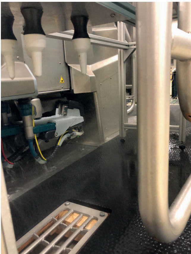
Bild 6: Melkzeugaußenreinigung (Bild: DLG)
