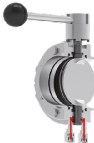
Bei geöffneter Ventilscheibe sind die Leckageanschlüsse automatisch geschlossen und verhindern zuverlässig den Verlust von Produkt.
