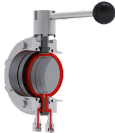
Bei geschlossener Ventilscheibe sind die Leckageanschlüsse geöffnet. Restprodukt vom Schaltvorgang kann sofort nach dem Schalten leer laufen und ausgespült werden.
