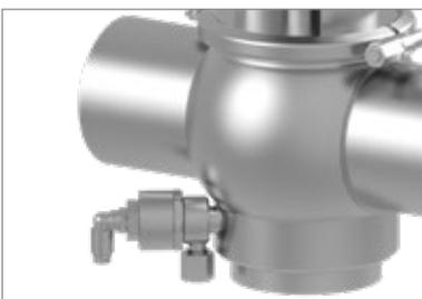
Doppeldichtventile, bei denen die Spülung des Leckageraums mit einem Medium über einer Temperatur von 80°C vorgenommen werden soll, sind mit einem Metallzylinder und einem Kolben aus PEEK ausgestattet.
