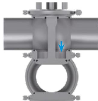
Ventiltyp U (Federschließend, NC)
