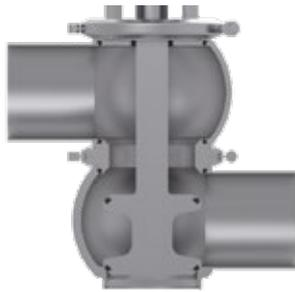
Ventiltyp W (Federschließend, NC)
