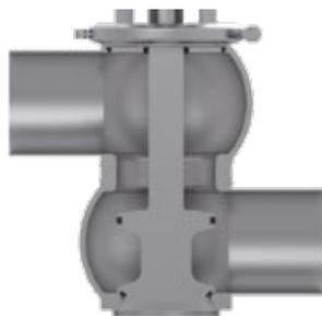
Ventiltyp W\_R (Federschließend, NC)
