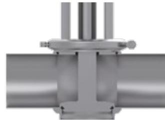
Einfache Absperrung mit nur einer Dichtung
