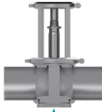
Ventiltyp N (Federschließend, NC)
