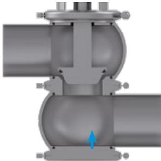
Regelventil mit linearem Regelkegel
