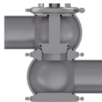
Regelventil mit weich-dichtendem Ventilteller
