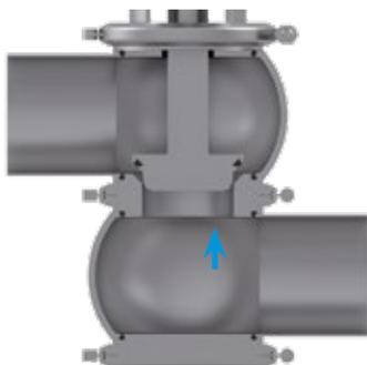
Regelventil mit gleichprozentigem Regelkegel
