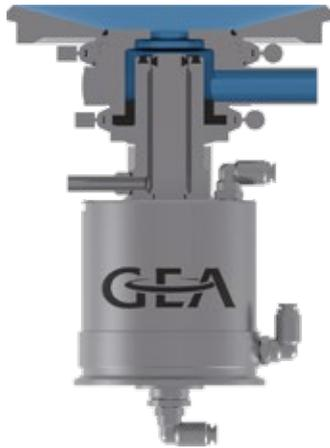
Bei einer Tank- bzw. Rohrreinigung wird der Ventilteller angeliftet und das Reinigungsmedium strömt in den Leckageraum. Dabei wird die Dichtung des Ventiltellers gereinigt und das Reinigungsmedium durch die Peripherie abgeführt. Der V-Ring des Doppeltellers dichtet das Reinigungsmedium gegen ein Eindringen in den Probenahmeraum ab.
