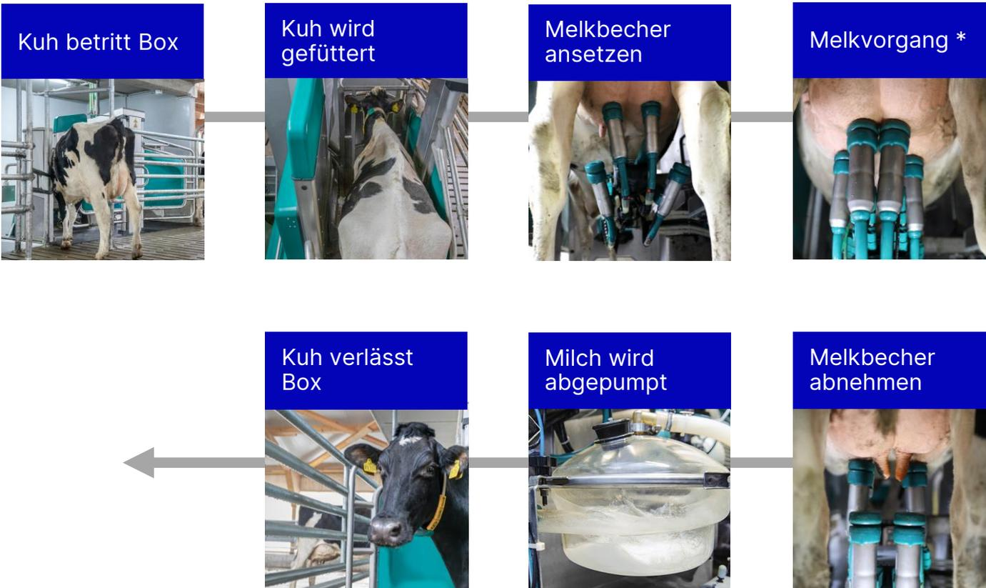
\* InlinerEverything<sup>®</sup>: Bei GEA erfolgt die Stimulation, das Zitzenreinigen, Vormelken, Melken und Dippen im Melkbecher. Die Zitzen-, Melkbecheraußen- und Kamerareinigung erfolgt mit warmem Wasser (min. 35 °C). Das ist angenehmer für das Tier und verbessert die Hygiene.
